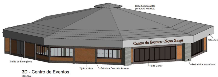
Figura 8 - Fachada da edificação - esquadrias de alumínio
