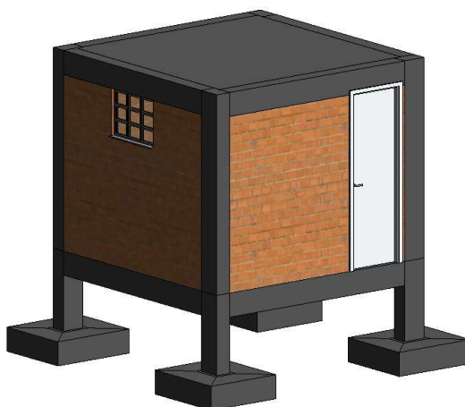
Figura 16 - Casa de bombas e suporta para caixa d'água de 20.000 litros
