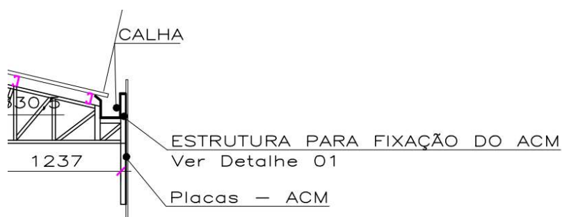
Figura 9 - Detalhe revestimento ACM.
