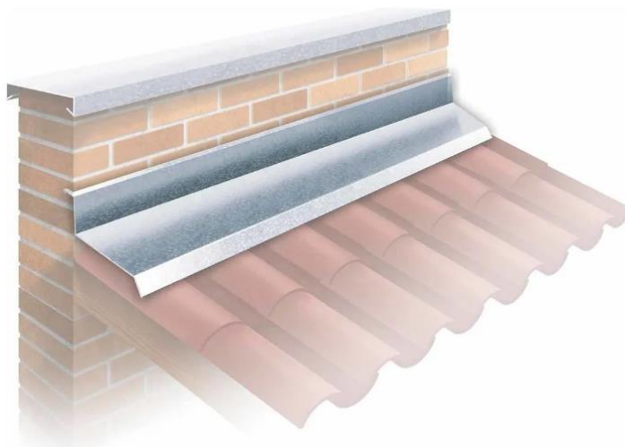
Figura 4 - Detalhe instalação Rufo
